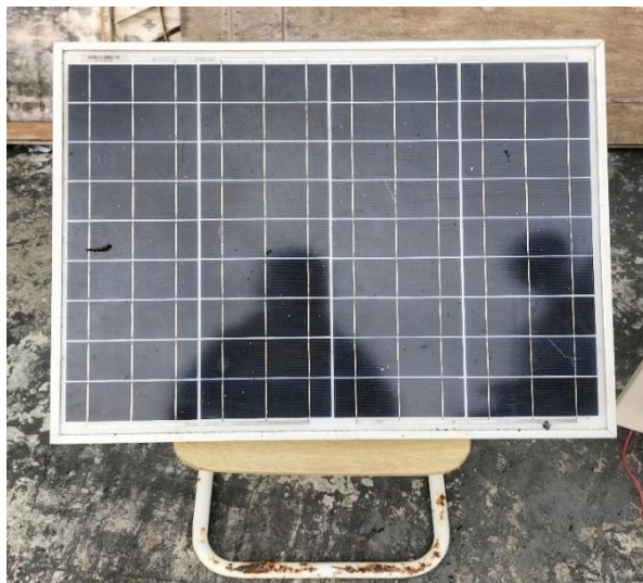
Gambar 4. 11 Kondisi Solar Cell Selama 3 Hari Tanpa Pembersih (Sumber : Hasil Karya Penulis)
